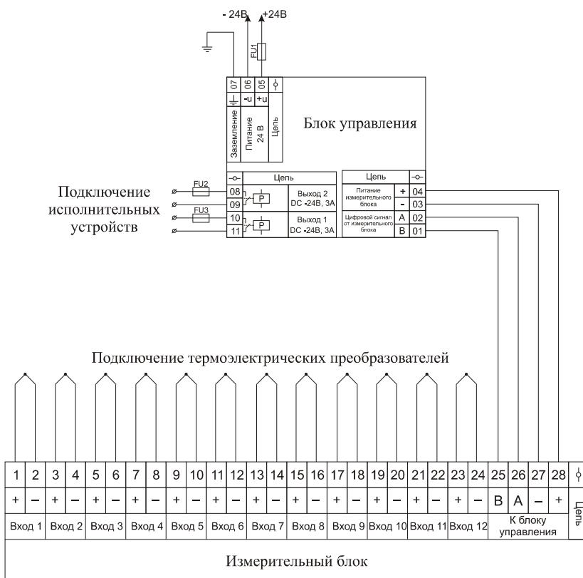
Рекомендуемые предохранители для цепи питания и цепей подключения исполнительных устройств (выход 1 и 2) к блоку индикации:
